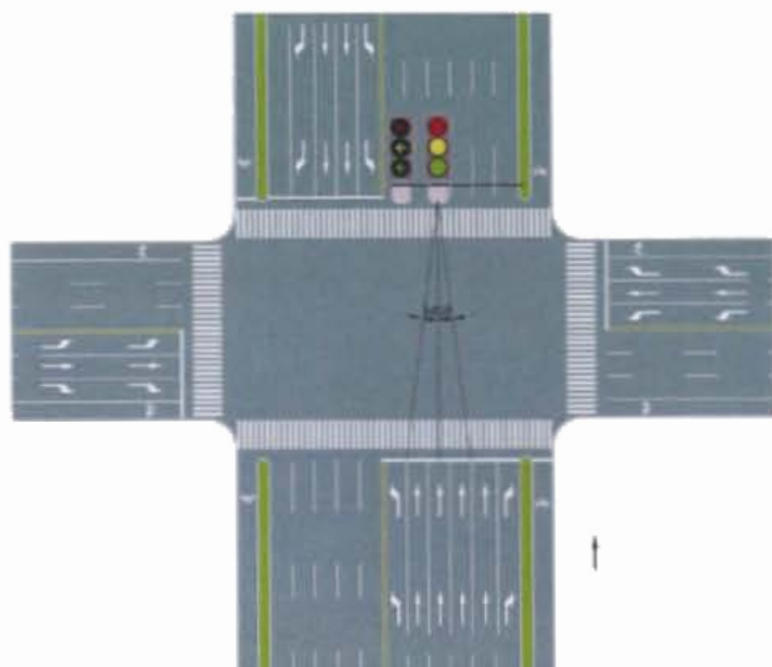
a) 信号灯组未能覆盖所指示车道示例
